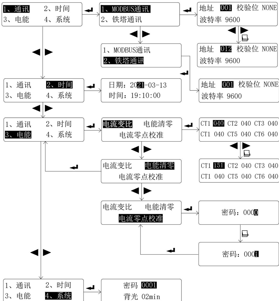
电流变比界面中的CT1-CT6表示出厂各回路对应变比，默认值为40，对应额定为 $5 \times 40 = 200\text{A}$ ，该处可通过翻页键调整参数，最大可设为999。
