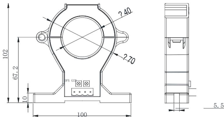
AHKC-EKB (100A/5V) 孔径  $\Phi$  40mm
