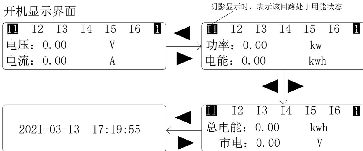
AMC16-DETT和AMC16L-DETT 基站直流电能计量模块设有 6 个计量分路，默认第 1 路为总计量，第 2、3、4 路分别为移动用户、联通用户、电信用户，第 5、6 路作为预留。
